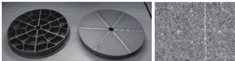
图 19 表面 CVD SiC 改性后常压烧结 SiC 分块的钎焊,及其焊缝显微形貌 [18,104]
