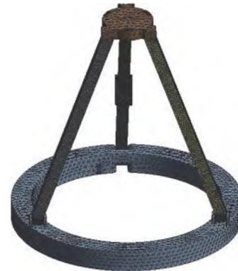
图 7 次镜展开机构的有限元模型
