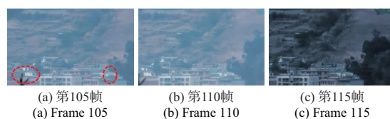
图 3 灰度等间距密度均衡算法增强图像
