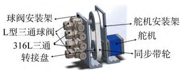
图2 球阀驱动模型
