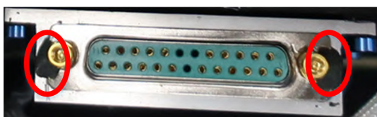
图 9 使用环氧胶对连接器附件进行加固,防止反向旋转时松脱
