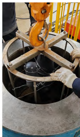
图5 耐压舱的耐压、密封试验
