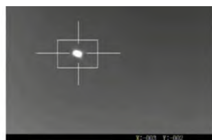
图 15 安装侧盖前相机显示脱靶量值
