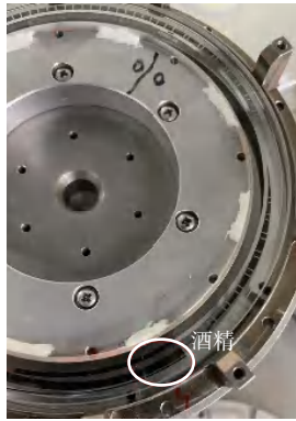
图10 圆光栅被酒精油污染
