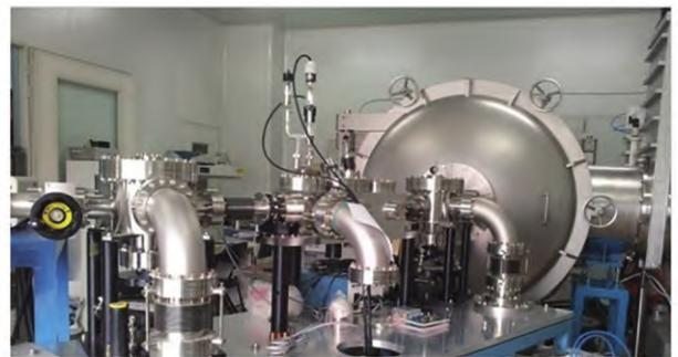
图 4 X 射线-极紫外-远紫外波段光电元器件检测和定标装置
