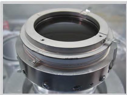
图 2 单光子计数面阵探测器实物照片
