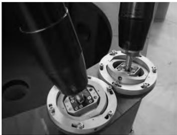
图 12 驱动电机安装在支柱底部
