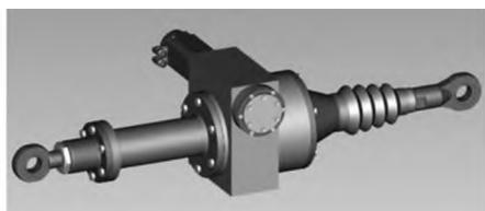
图 9 定位致动器组件 CAD 视图
