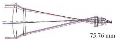
图 3 红外光学系统结构图
