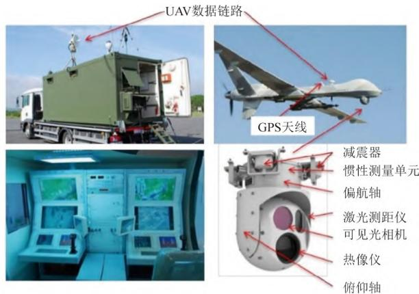
图1 航空光电载荷系统组成
