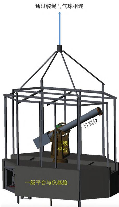
图4 (网络版彩图)球载日冕仪系统基本结构示意图. 整个系统由一级平台与仪器舱、二级平台、日冕仪组成
