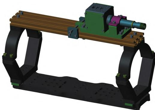
图 14 (网络版彩图)日冕仪设备连接架组件结构实体图. 上面架着的是精跟踪相机(绿色单元)
