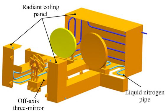
图 3 准直系统结构
