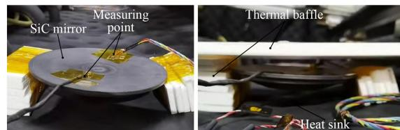
图 13 280 mm SiC 镜坯液氮快速制冷实验
