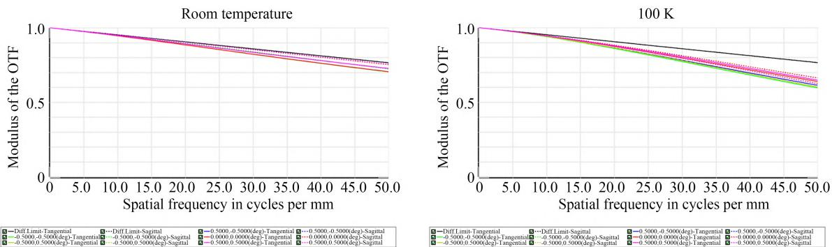
图 12 准直系统的 MTF (@50 lp/mm)
