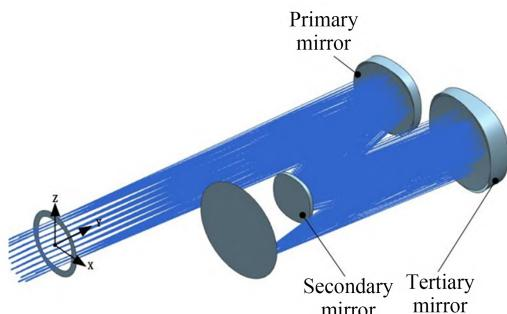
图 1 离轴三反准直系统光路
