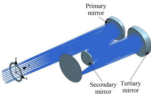
图 1 离轴三反准直系统光路
