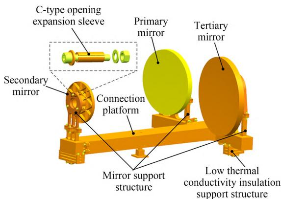
图 2 离轴三反结构示意图
