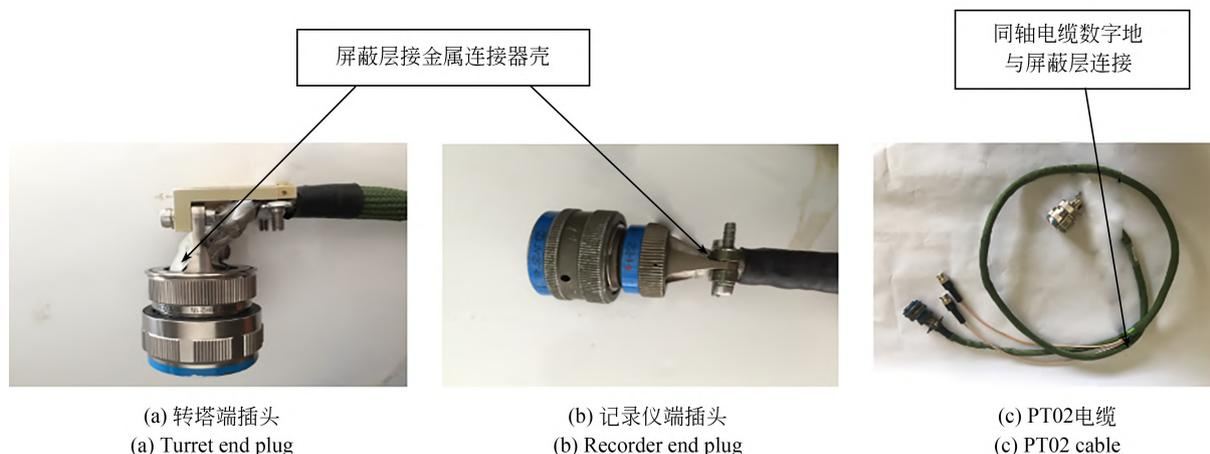
图 17 电缆屏蔽处理
