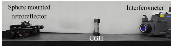
图 16 干涉补偿检测光路
