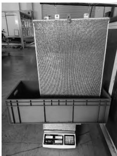
图10 含水率试验装置
