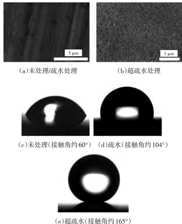
图1 表面微观形貌及接触角
