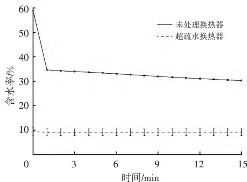
图11 超疏水换热器含水率测试结果
