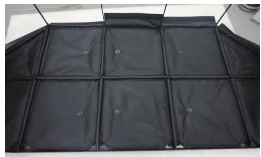
图 7 遮光罩内部包覆 MLI 状态
