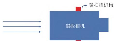
图 9 标定系统构成示意图
