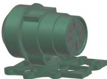
图4 整机有限元模型
