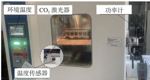
图 11 CO<sub>2</sub> 激光器高低温实验平台
