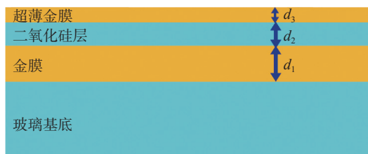
图 1 提出的三层金-氧化硅-金薄膜结构示意图
