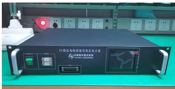
图 11 高压放大器机箱实物
