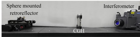
图 16 干涉补偿检测光路
