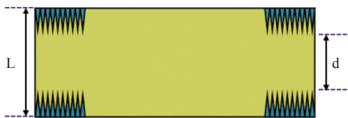
图10 锯齿微结构激光器的结构示意图
