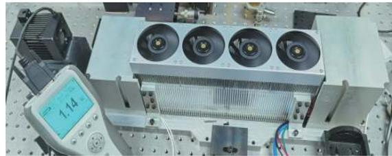
图6 紧凑型波长自动调谐脉冲 CO<sub>2</sub> 激光器实物图
