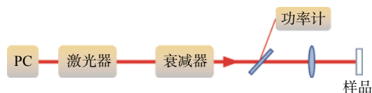
图 3 飞秒激光损伤系统原理图
