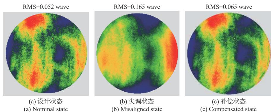
图10 不同状态下干涉仪测量结果(去除部分高频量)
