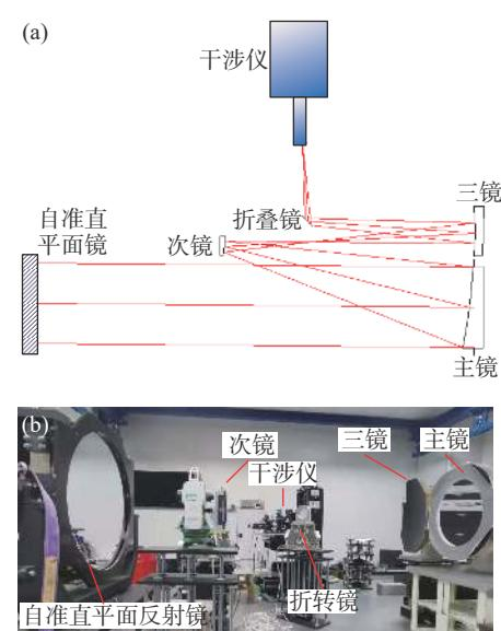
图 1 500 mm 离轴三反光路图。(a)示意图及(b)实验图
