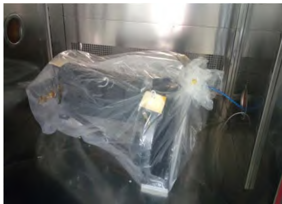
图 14 主光机结构高低温循环试验环境
