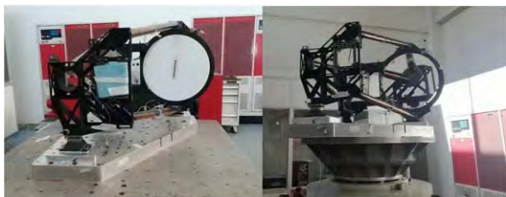
图 13 随机振动力学筛选试验
