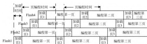
图3 NAND Flash 4级流水编程时序
