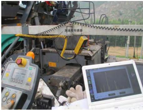
图7 多频振动频率测试系统数据现场采集
