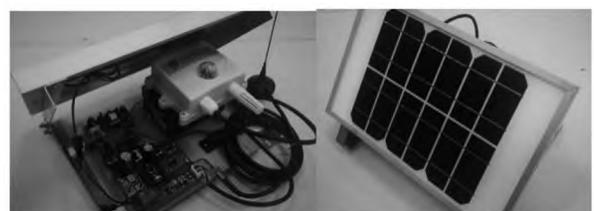
图6 环境参数检测子系统实物图
