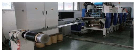
图 12 热熔预浸线实物图
