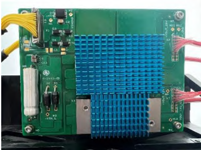
图 6: 电源板实物图
