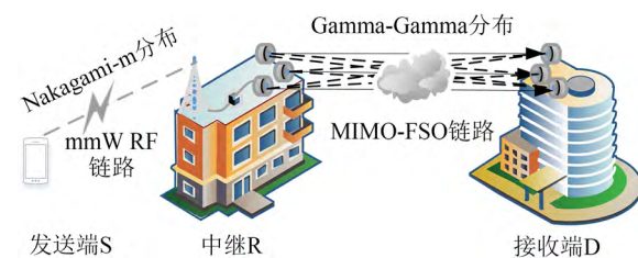
图1 混合毫米波RF/MIMO-FSO中继系统
