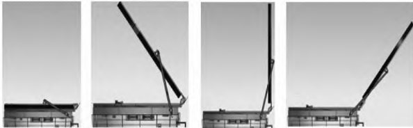
图 4 空间开合机构的运动过程
