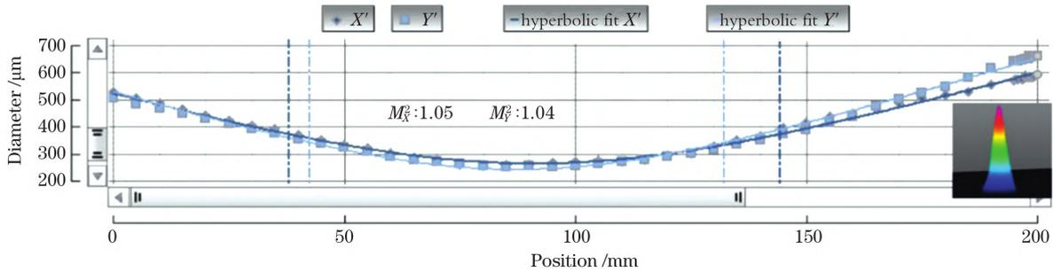
图 2 泵浦功率为 3 W 时的光束质量因子, 右下方插图光强的三维分布图
