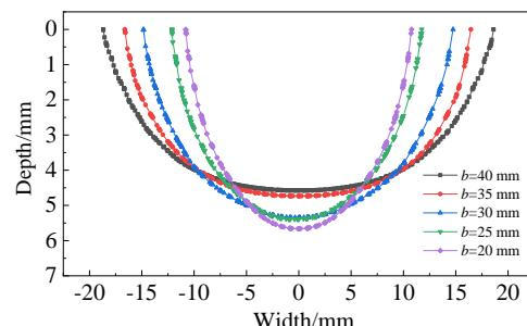
图 12 不同光斑宽度对淬硬层形貌的影响
