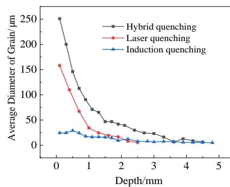
图 15 3 种淬火方式淬硬层沿深度方向平均晶粒直径对比
