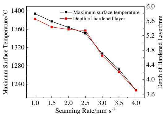
图 11 扫描速度对复合淬火表面温度和硬化层形貌的影响
