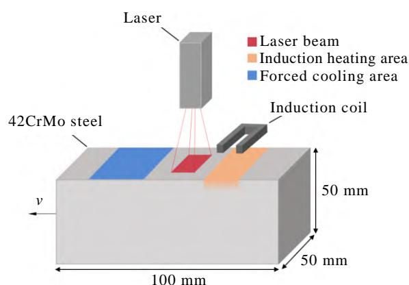
图 1 激光-感应复合淬火工艺示意图
