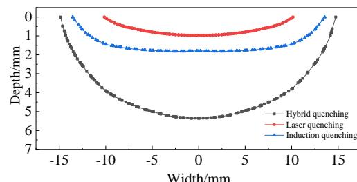
图 8 3 种淬火方式淬硬层形貌
