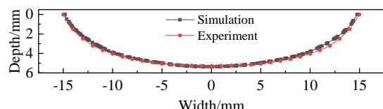
图 7 复合淬火实验所测淬硬层曲线与模拟结果比较
