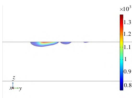
图 3 激光-感应复合淬火横截面温度场模拟结果
