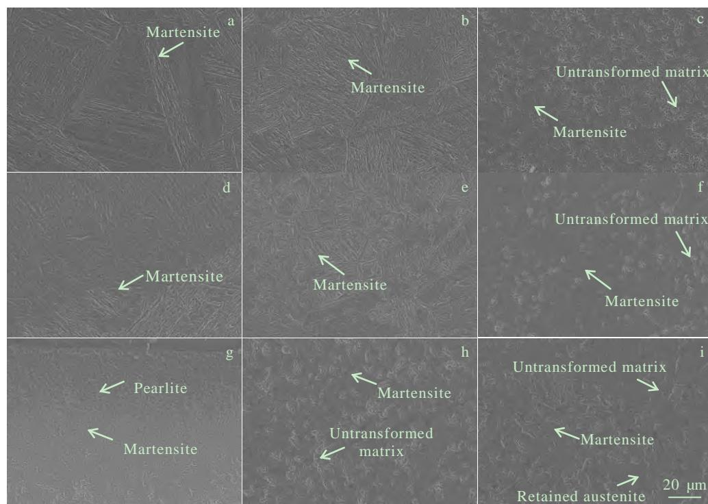
图 18 3 种淬火方式淬硬层显微组织
