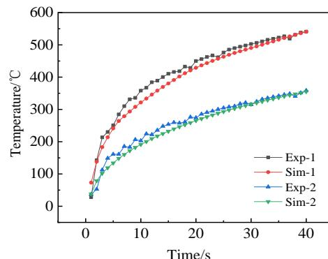
图 4 感应加热实验测温与模拟结果比较
