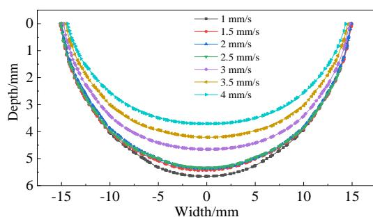
图 10 不同扫描速度下硬化层形貌
