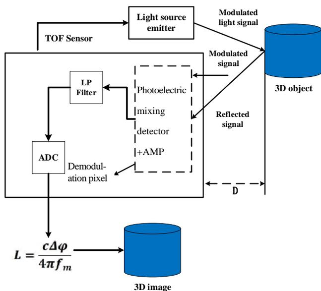
图 2 间接测量法相位解调原理图
