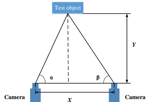
图 4 双目视觉测距示意图
