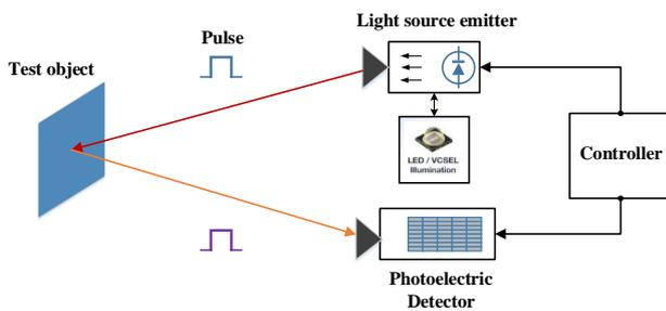
图 1 TOF 相机的工作原理
