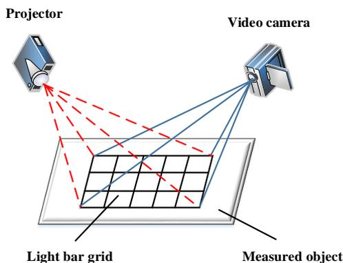
图5 结构光基本原理图
