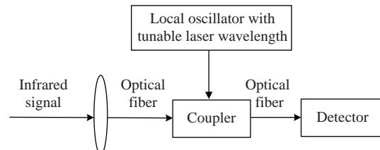
图 5 激光本振单元探测器原理框图
