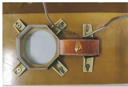
图 3 二维八角对称结构 PEM 实物图
