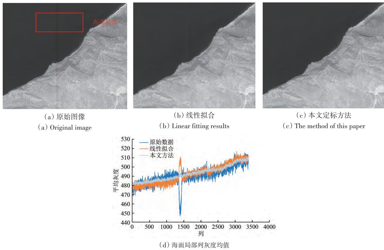
图7 索马里PAN谱段相对辐射校正对比图
