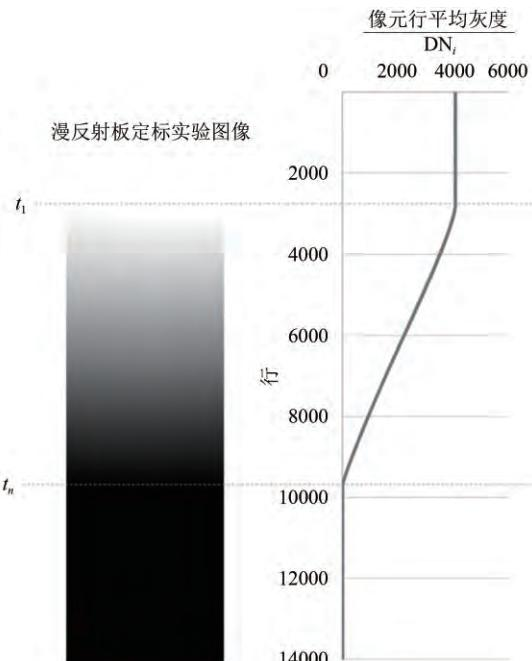
图5 漫反射板PAN谱段定标测试图像
