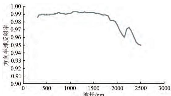
图 2 漫反射板方向半球反射率
