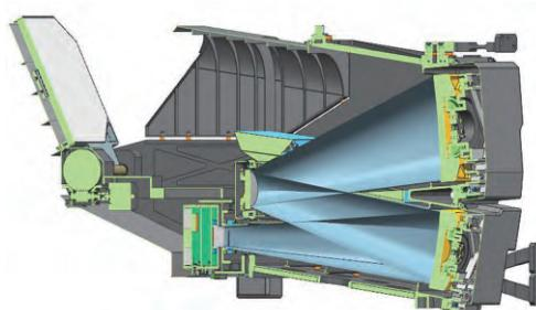
图 1 吉林一号光谱星星上定标装置
