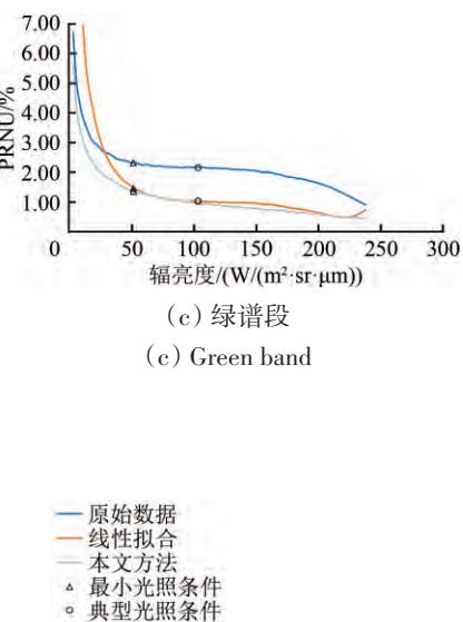
图8 各谱段非均匀性测试结果曲线
