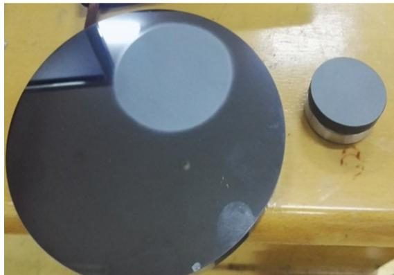
图15 行星运动加工后镜片(左:加工后工件 右:研磨盘)
