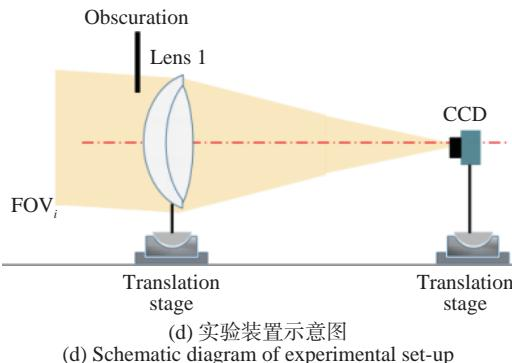
图 7 dOTF 实验装置图
