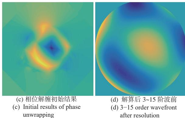
图 4 多项 Zernike 组合的 dOTF 计算过程
