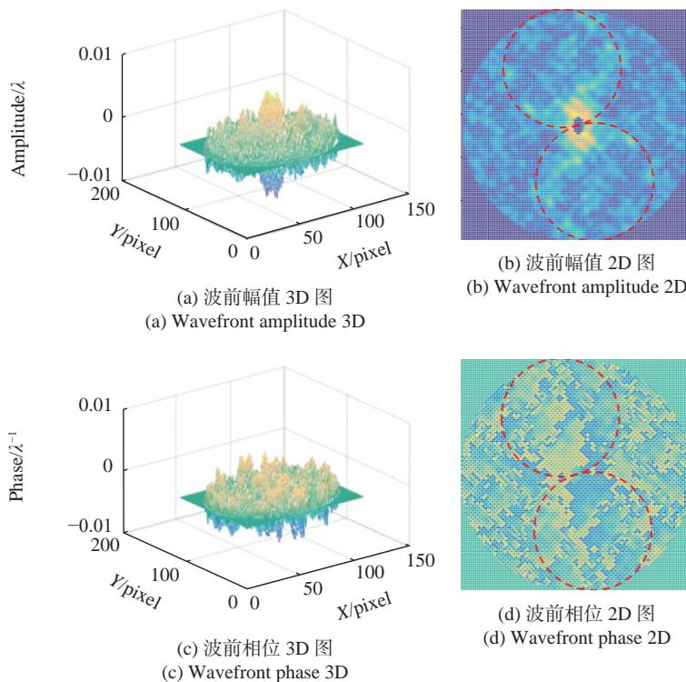
图 8 幅值与相位分布测量结果
