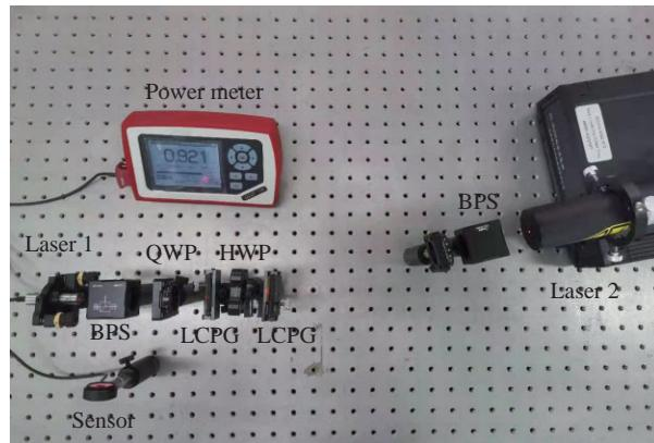
图 5 OC-LCPGs 收发分离结构验证实验图
