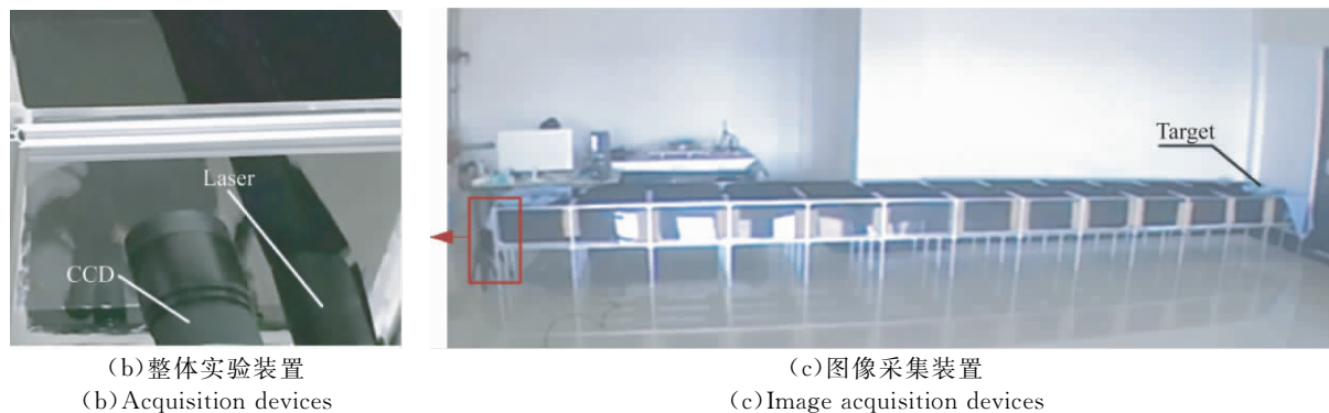
图 3 短相干光源水下远距离目标成像实验原理及装置
