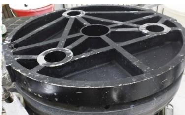
图 8 反射镜和支撑结构
