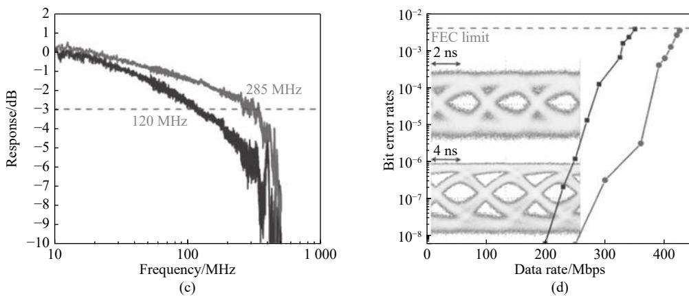
图 9 (a) 使用蓝光激光二极管和 ox-CDs 荧光粉产生的白光光谱; (b) 小信号频率响应和数据传输测量原理图; (c) ox-CDs(黑线)和蓝色激光与 ox-CDs 组成的白光源(红线)的频率响应; (d) ox-CDs(黑线)和白光(红线)的 OOK 线在不同数据速率下的误码率<sup>[10]</sup>
