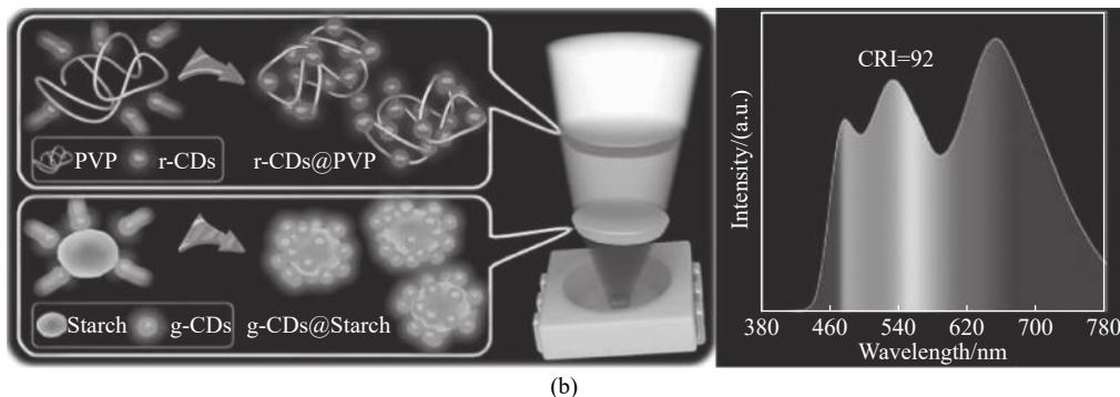
图 8 (a) 基于以柠檬酸和 b-PEI 为原料合成的 CDs 荧光粉的 WLED<sup>[39]</sup>; (b) 基于 g-CDs@starch 和 r-CDs@PVP 荧光粉的 WLED<sup>[43]</sup>
