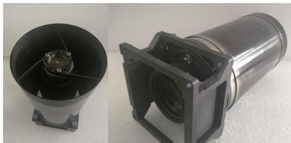
图 12 折反射光学系统样机
