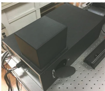
图 7 像场调制傅里叶变换成像光谱仪样机
